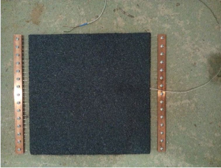
Obr. 5 Cílené vyhřívání vzorků pomocí elektrické odporové mřížky
