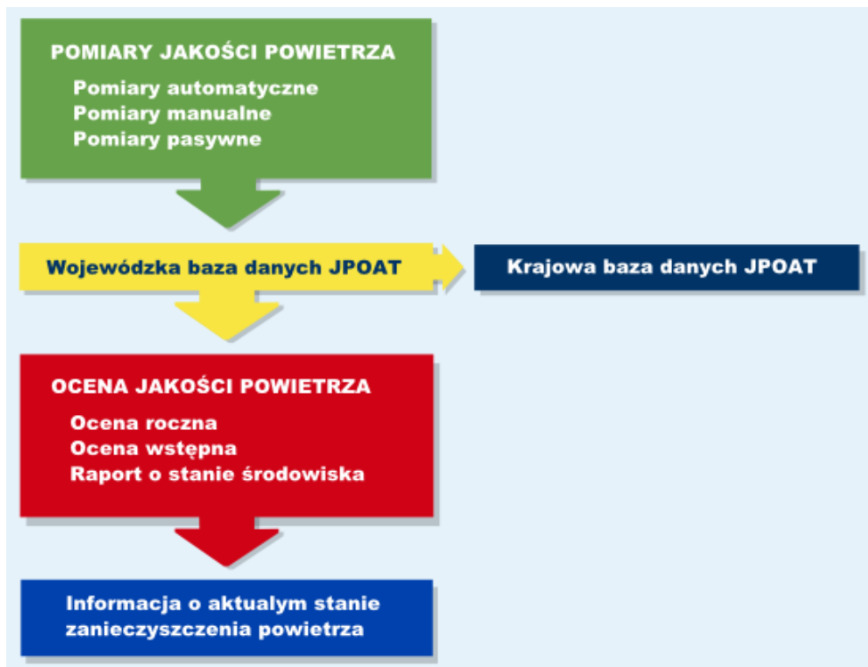
Rysunek 4.1 Schemat funkcjonowaniu monitoringu ochrony powietrza
