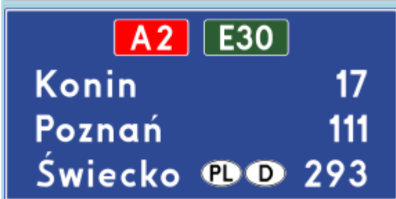
E-14a: tablica szlaku drogowego na autostradzie
